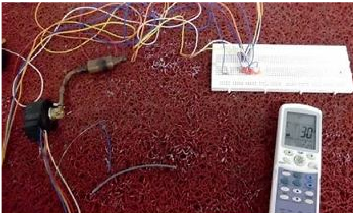
Figura 23 - Ensaio da Válvula de Expansão Eletrônica Fonte: Elaborado pelo Autor
